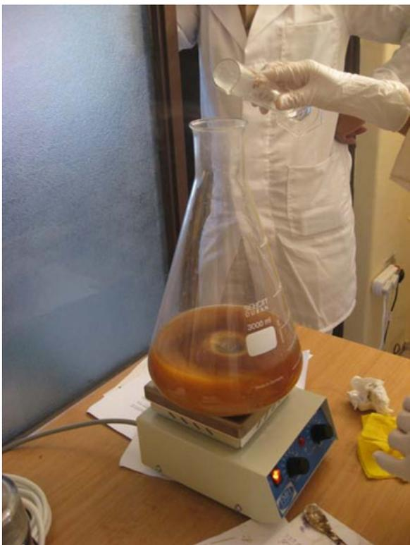
Una vez agregado todo el ácido clorhídrico, el matraz se coloca en el refrigerador durante la noche. Luego, el PTA HCl sólido se filtra a través de un filtro de 20 cm con un papel previamente pesado y el sólido amarillo oscuro se deja secar. Después de retirar el sólido, ambos papeles de filtro (del TA y del PTA HCl) se pueden agregar al balde que contiene la raíz más fresca para recuperar los alcaloides que se encuentran en ellos.
